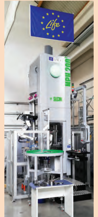
Impianto pilota SACMI MPH2002 - DWL per compattazione ad alta densità di polveri metalliche
